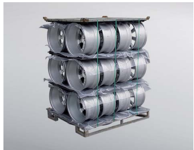
Standardisierte Zwischenlagen für stehenden Rädertransport
